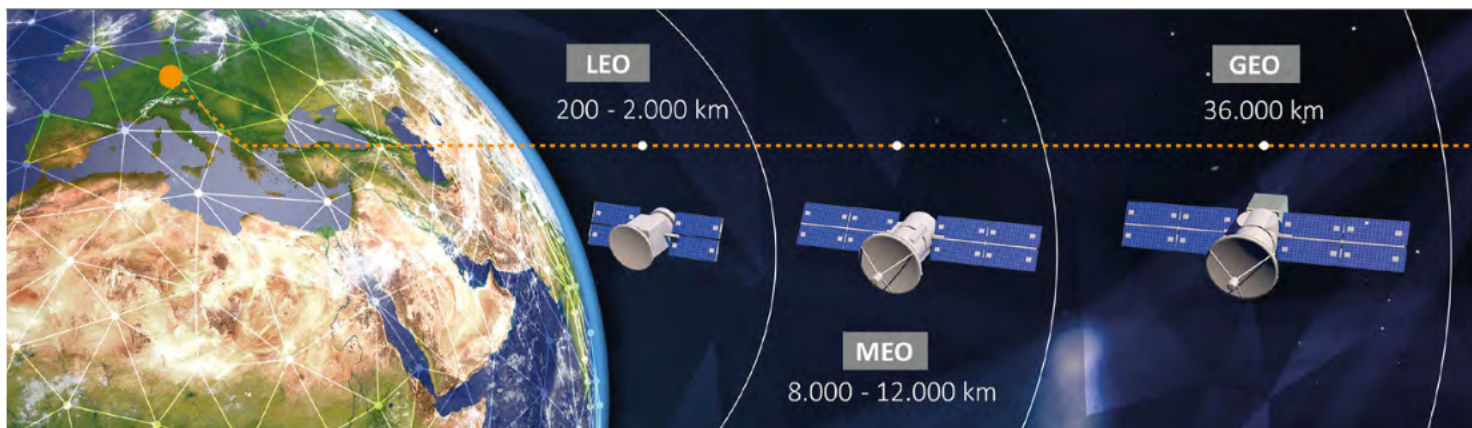
Multi-Orbit-Struktur im LEO (Low Earth Orbit), MEO (Medium Earth Orbit) und GEO (Geostationärer Orbit)
