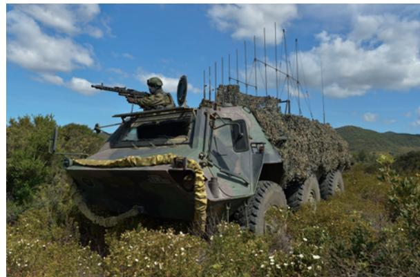
**EloKa-Kräfte können mit dem Störpanzer „Hummel“ den gegnerischen Funkverkehr stören oder den gegnerischen Einsatz von Drohnen erschweren,
