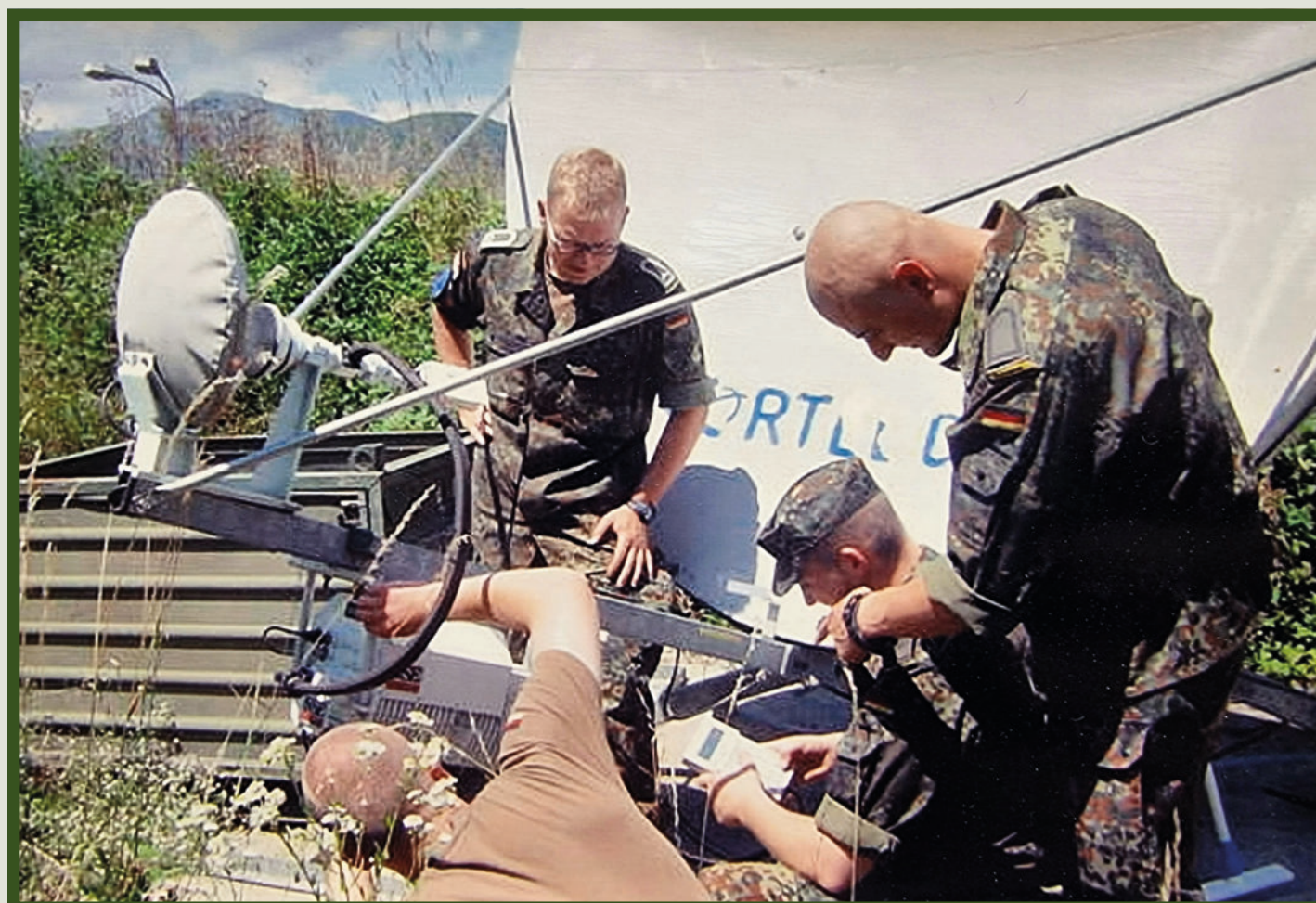
Feldweibel Kappel mit seinem Trupp beim Abbau einer Ku-Band Satcom-Bodenstation in Filipovici (Bosnien)
