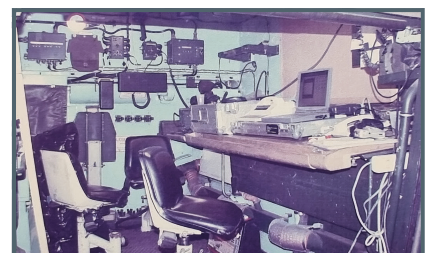
Der mobile Arbeitsplatz einer Satcom-Mehrkanal-anlage, mit der die Verbindung zu den Einsatzkräften der Bundeswehr gehalten wird
