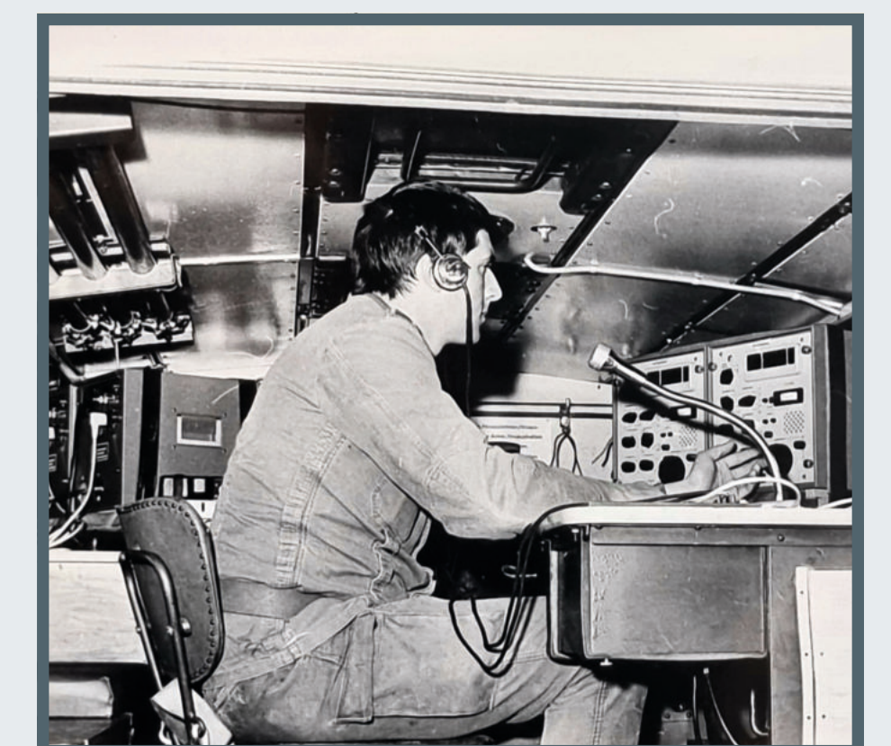
Horch-/Peiltrupp VHF (1 – 80 MHz) auf LKW 1,5 t (Unimog). Die Bilder zeigen den Bedienerplatz und den auf- gebauten Trupp mit Antenne, Stand- betrieb und SCAM-Mast (um 1982)
