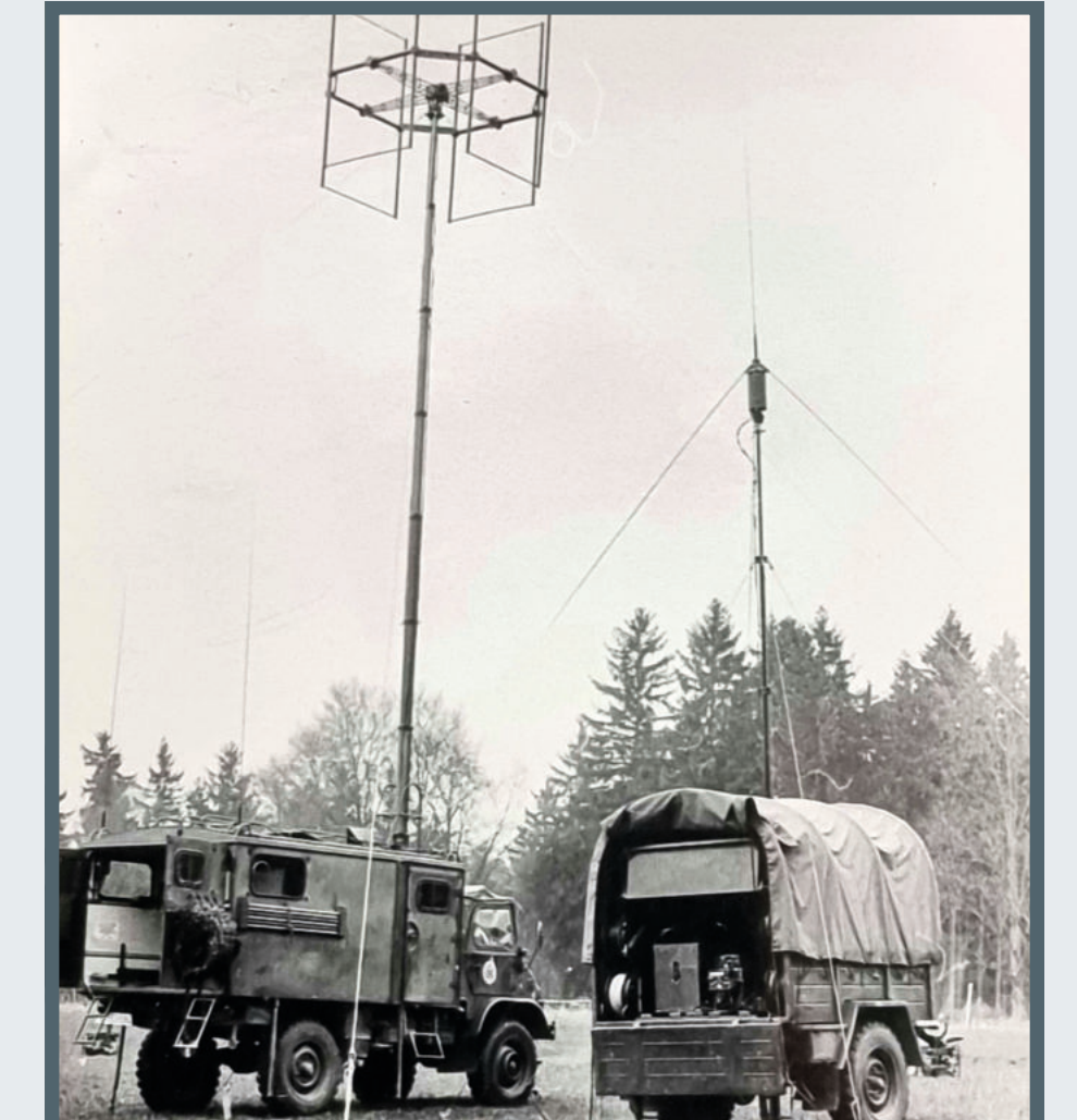
Horch-/Peiltrupp VHF (1 – 80 MHz) auf LKW 1,5 t (Unimog). Die Bilder zeigen den Bedienerplatz und den auf- gebauten Trupp mit Antenne, Stand- betrieb und SCAM-Mast (um 1982)
