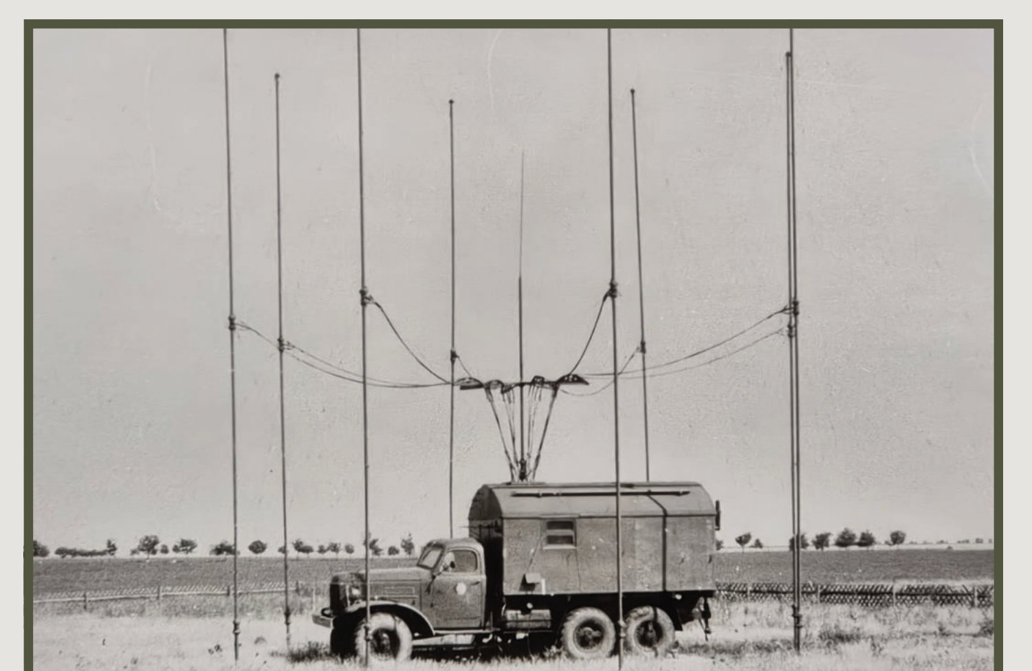
Zentraler Funkdienst (ZFD) – Funkaufklärungs-Regiment – Entfaltete mobile Funkaufklärungszentrale – Adcock-Peiler – (1986)
