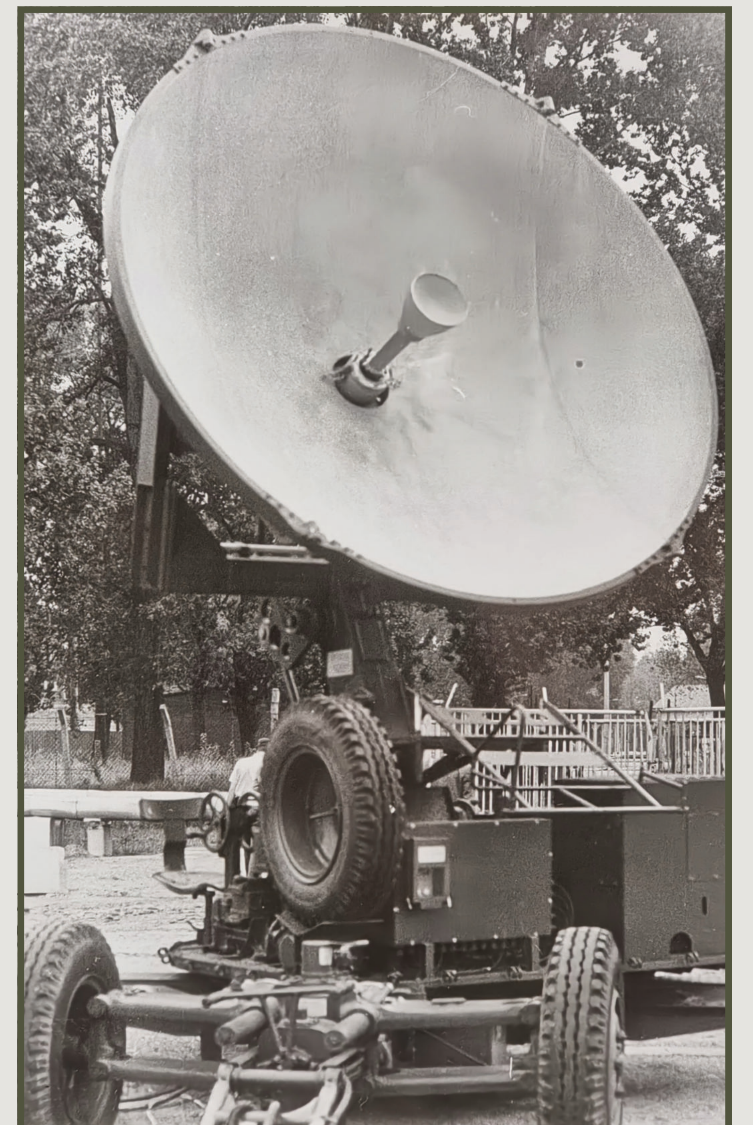
Zentraler Funkdienst (ZFD) – Dessau – Funkaufklärungs-Regiment – Die Antenne einer Satelliten-Aufklärungsanlage auf dem Lafettenhänger eines Flak-Geschützes montiert (1989)
