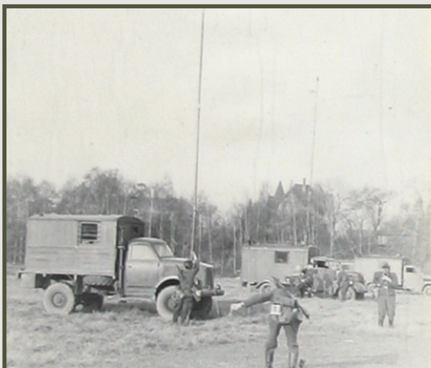
Funkstationen mittlerer Leistung der KVP (1. Gerätegeneration)
