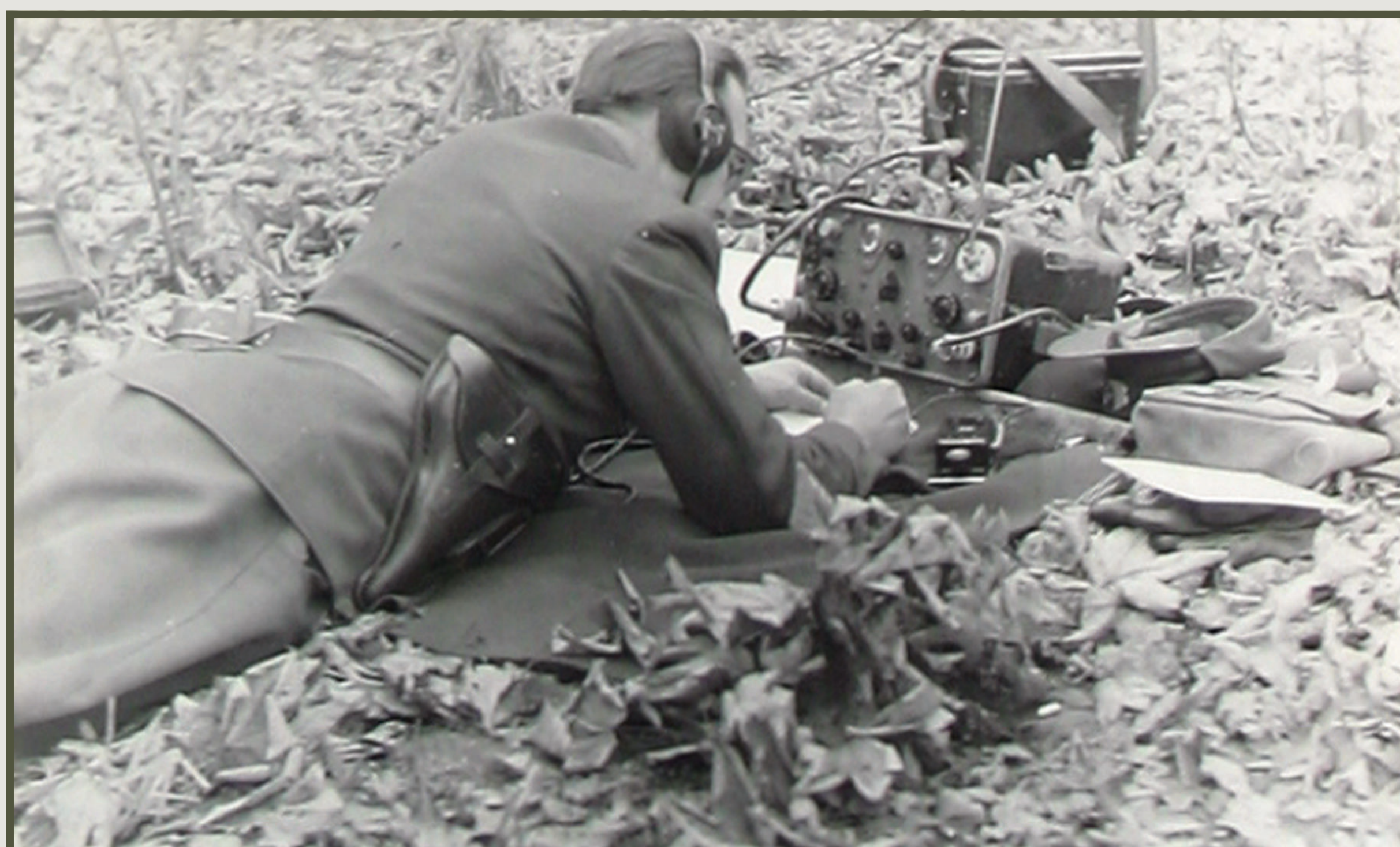
Funkstation kleiner Leistung „FK 1“ Die tragbare Version eines Tornisterfunkgerätes aus der DDR-Produktion oben der Geräte-, unten der Batterie-Tornister
