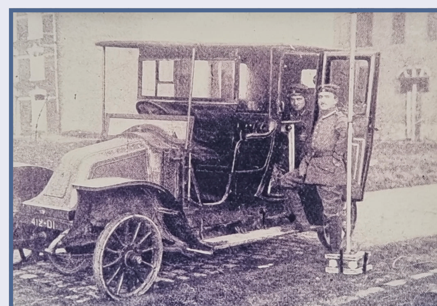
„Leichte Automobil-Funkenstation“ Während des Krieges wurden etwa 40 Stationen dieser Art gebaut und im Bereich der Armee-Telegraphentruppen eingesetzt
