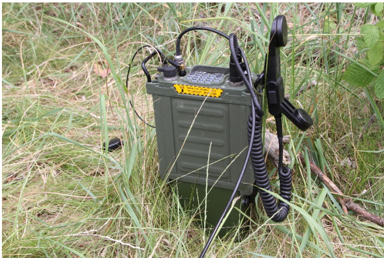
Bild 2: Das PRC-160 kann plattformgebunden oder als Manpack abgesehen genutzt werden. Es wiegt rund 4,1 kg ohne Batterien. (Foto: Bundeswehr/Engler)
